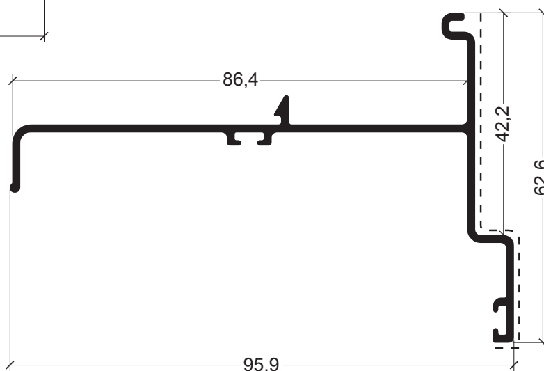
ADR 1385 Bota aguas de abrir para D.V.H. con contravidrios 0,778 kg/m
