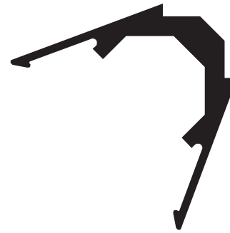
ADR 65 Escuadra de tracción parte externa 0,677 kg/m
