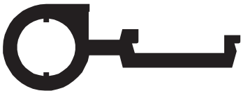
ADR 369 Bisagra Rotonda 700 parte marco 0,629 kg/m
