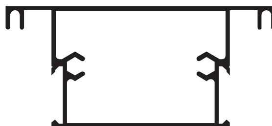
ADR 97 Travesaño puerta de 36 mm 0,803 kg/m
