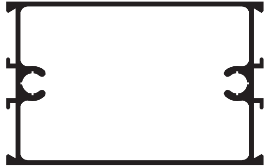
ADR 14 Travesaño puerta de 44 mm 1,054 kg/m
