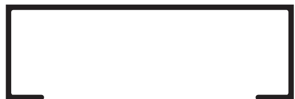
ADR 245 Canal liso 25 x 75 mm 0,526 kg/m
