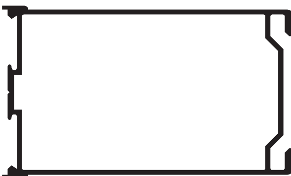
ADR 16 Parante puerta bisagra encolizada 1,000 kg/m - L = 6170 mm.
