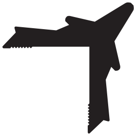
ADR 64 Escuadra de tracción parte interna 0,917 kg/m
